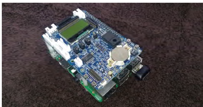
Raspbbey Piボードに装着した例(下がRaspbbey Pi)
